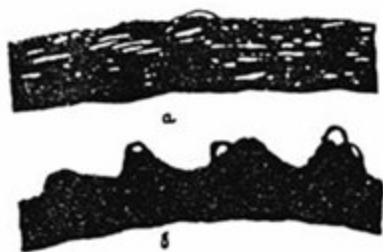
Рис. 11. Выдавливание проволок прядей: а - в одной пряди, б - в нескольких прядях
